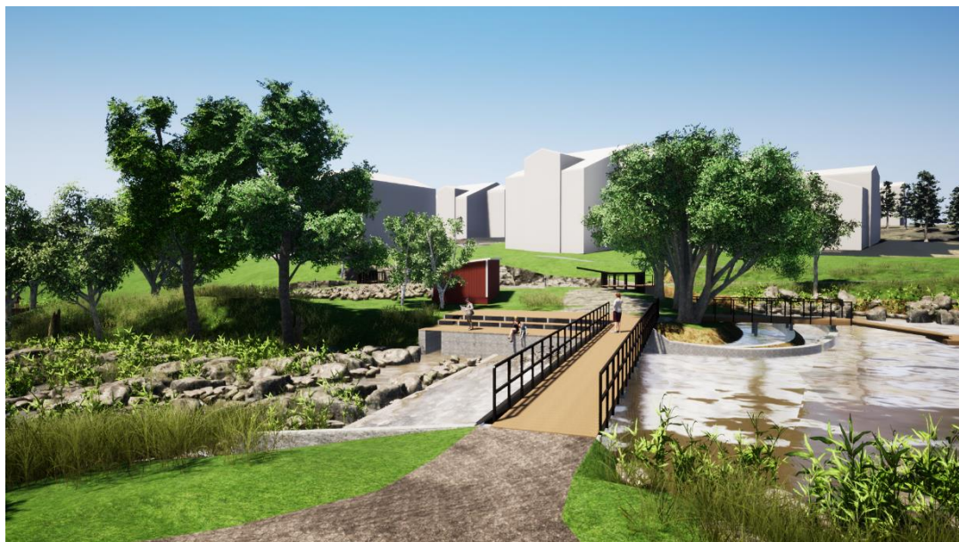
Figur 33. Visualisering av Slussholmen efter byte av dämme och fiskvandningsväg. Vy över dämnet från östra stranden. Notera att fiskvandningsvägen är flyttat till Slussholmen och att övergången över dämnet är bredare. Norr om Slussholmen kan det övre inlöpet till fiskvandningsvägen ses tillsammans med den nya bryggan. (Österåkers kommun visualiseringsenheten)
