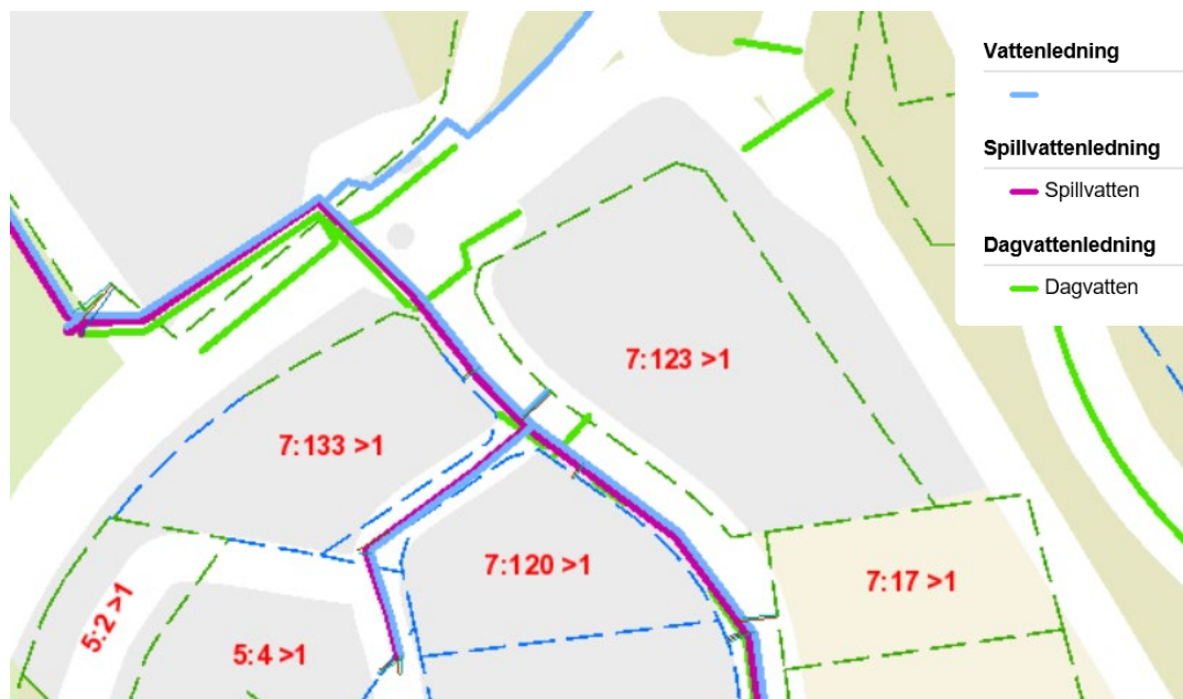
Figur 7. Anslutningspunkter för vatten och spillvatten.
