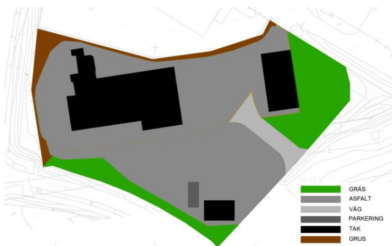
Figur 21. Markanvändning för planområdet använd för flödesberäkningar. Infarten flyttad enligt Figur 15. (Dagvattenutredningen)
