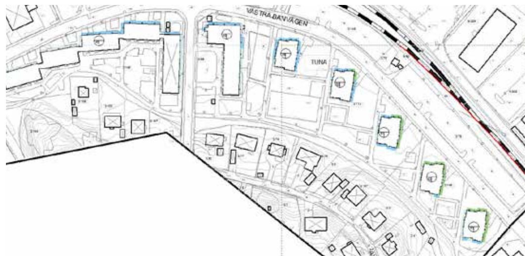
Figur 19. Färgerna utmed fasaderna visar framtida högsta förekommande ekvivalenta ljudnivåer för byggnaderna öster om stationen.
