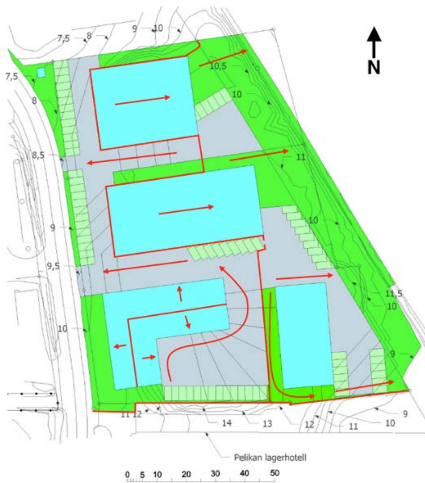
Bild 11. Avrinningsvägar efter föreslagen exploatering av planområdet, sedan bilden togs fram har mindre ändringar gjorts i situationsplanen.
