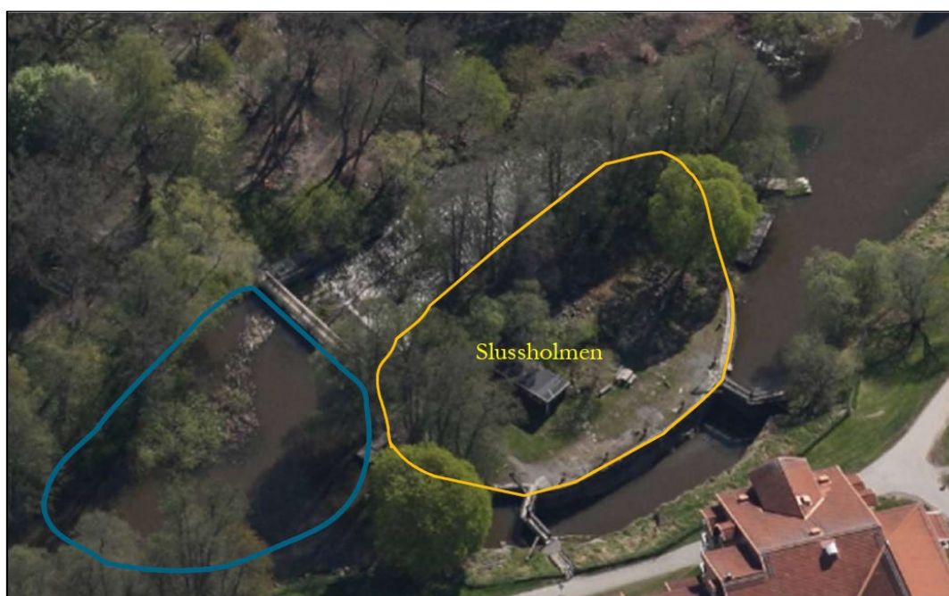
Figur 23. För att återställa det vattendjup som förelåg uppströms dämet när det var nyanlagt kommer vassruggen och sediment inom blå markering att avlägsnas/muddras.
