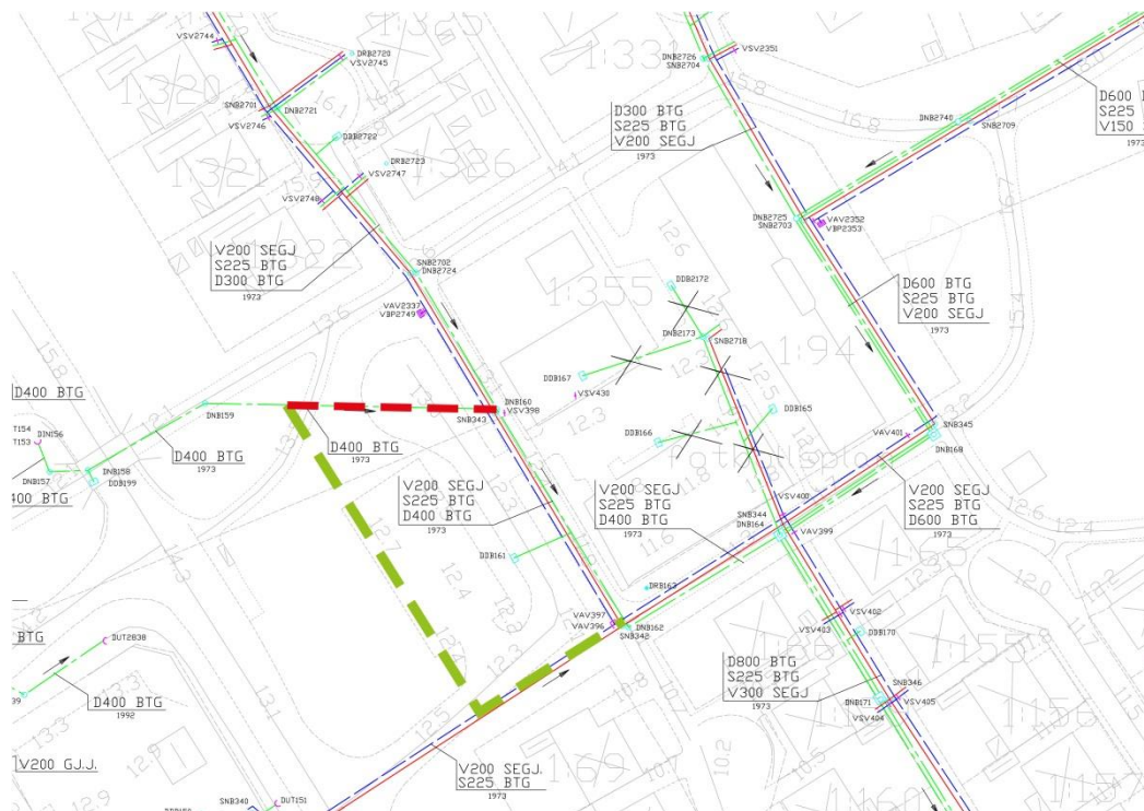
Bild 17. Förslag på ny dragning av dagvattenledning markeras med streckad linje i grönt, befintlig ledning visas i rött.
