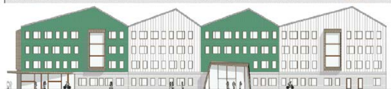
Shingel (plåt eller trä) + brädgjutet & målad betong
