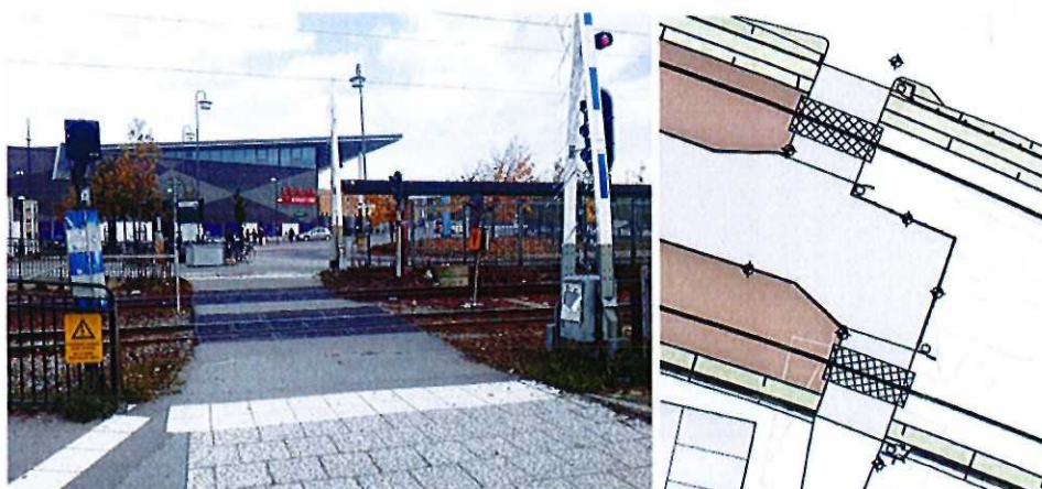
Befintlig plankorsning för gång- och cykeltrafik öster om Åkersberga station samt föreslagen chikanlösning vid östra plankorsningen sedd uppifrån. WSP.
