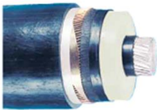
Figur 15. Enfaskabel för markförläggning. Innerst en ledare av aluminium. Utanför ledaren isolation av PEX samt ytterst ett skyddshölje av polyeten. Källa: ABB.
