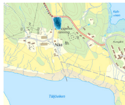
Länsstyrelsens kartering av lågpunkter med risk för ansamling av vatten vid höga nederbörds mängder visar på ett riskområde inom planområdet.
