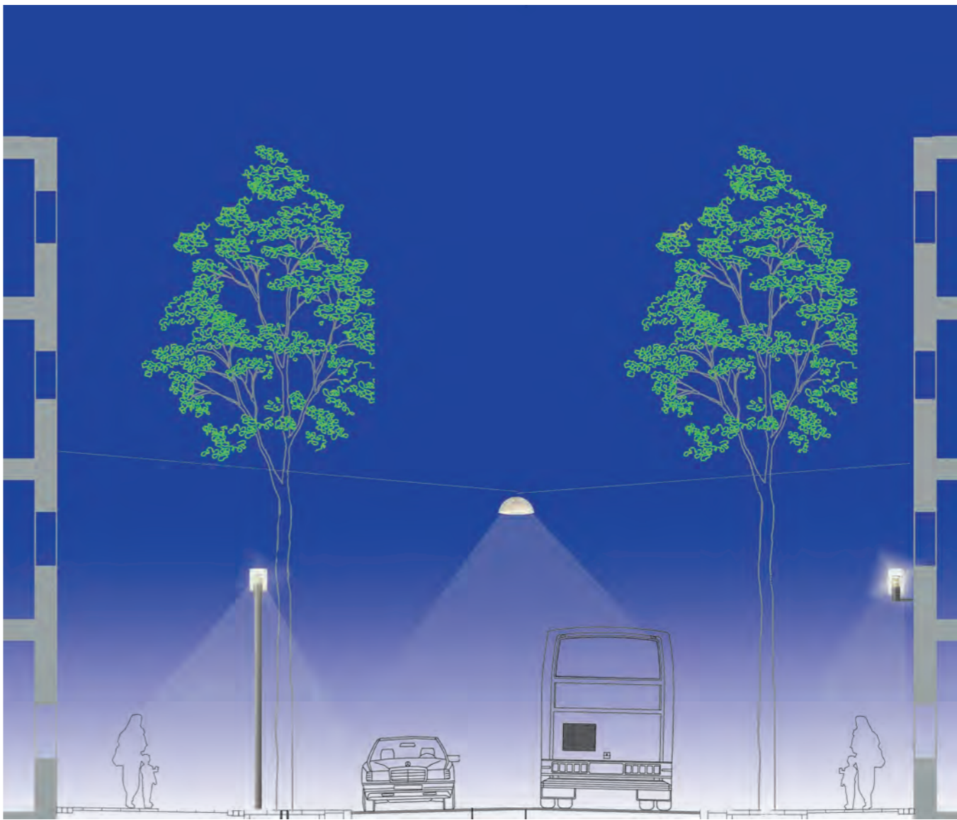
Huvudgatan nära Årstadstorget med med linspänd belysning samt 4 m stolpe och vägghängd armatur
