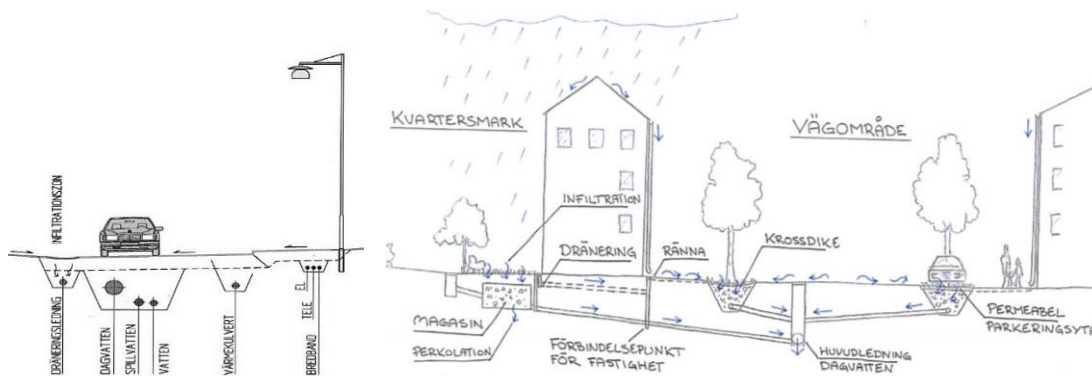
Principsektion dagvatten i gata
