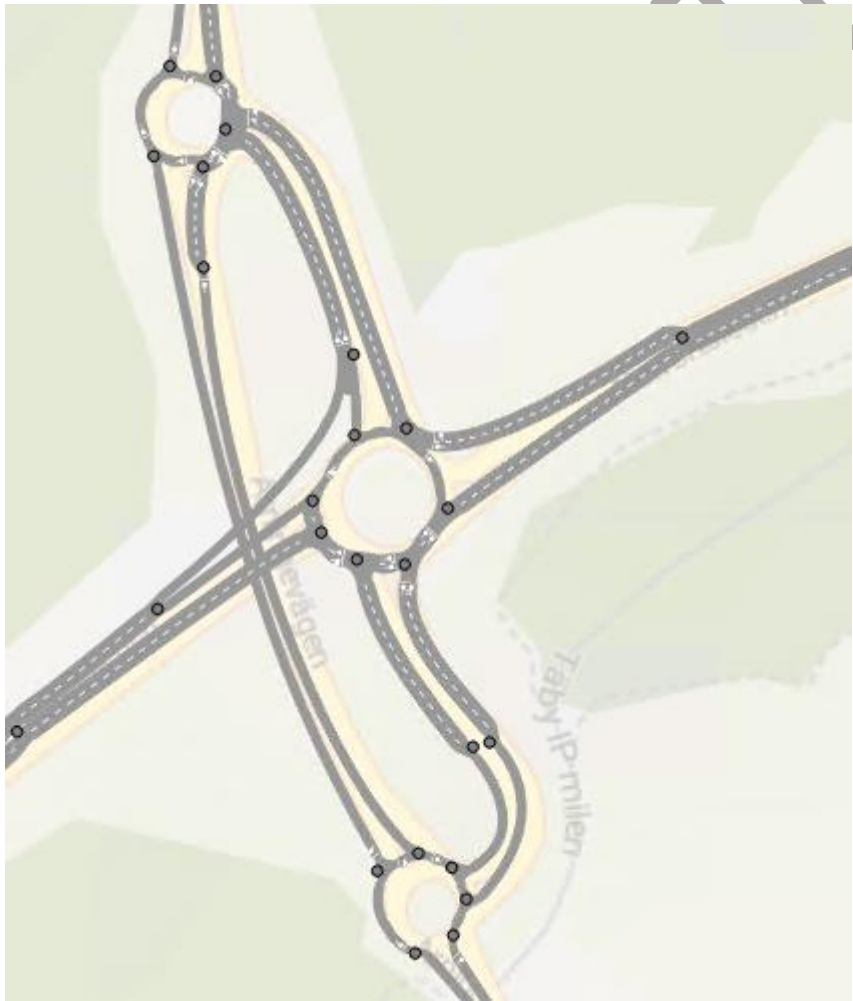
Figur 3 Trafikplats Mossen - utformning droppe alt. 2 från ÅVS Arningevägen
