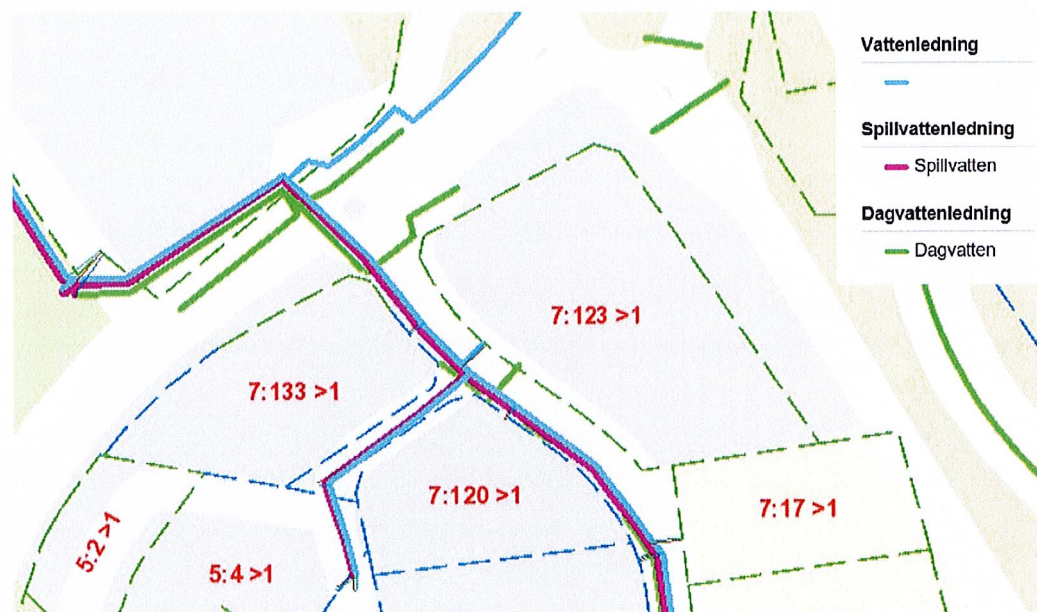
Figur 7. Anslutningspunkter för vatten och spillvatten.
