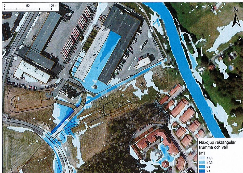
Figur 20. Visar maxdjup med en rektangulär trumma under den nya planerade infarten till Säbydepån. Infarten till planområdet flyttas därför enligt Figur 15. Pilar visar de större rinnvägarna från uppströms områden. (Dagvattenutredningen)
