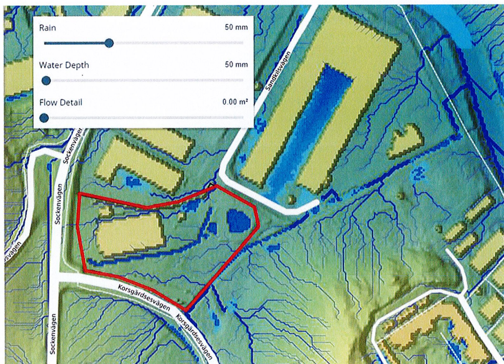
Figur 17. Områden med risk för översvämning med vattendjup mer än 50 mm i befintlig situation är markerade med blått. Plangränsen är markerad med röd linje. (Dagvattenutredningen)
