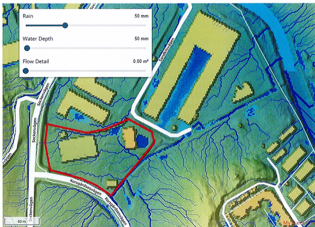
Figur 18. Områden med risk för översvämning med vattendjup mer än 50 mm med hänsyn till ny byggnad, framtida situation är markerade med blått. Plangränsen är markerad med röd linje. (Dagvattenutredningen)
