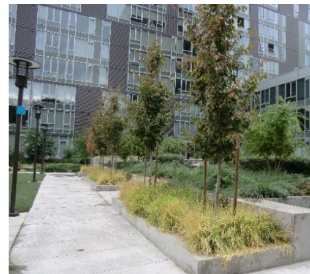
Exempel på trädplantering i skelettjordar och på gröna gårdar för robust dagvattenhantering (bilder från VA-utredning: Sweco, 2018).
