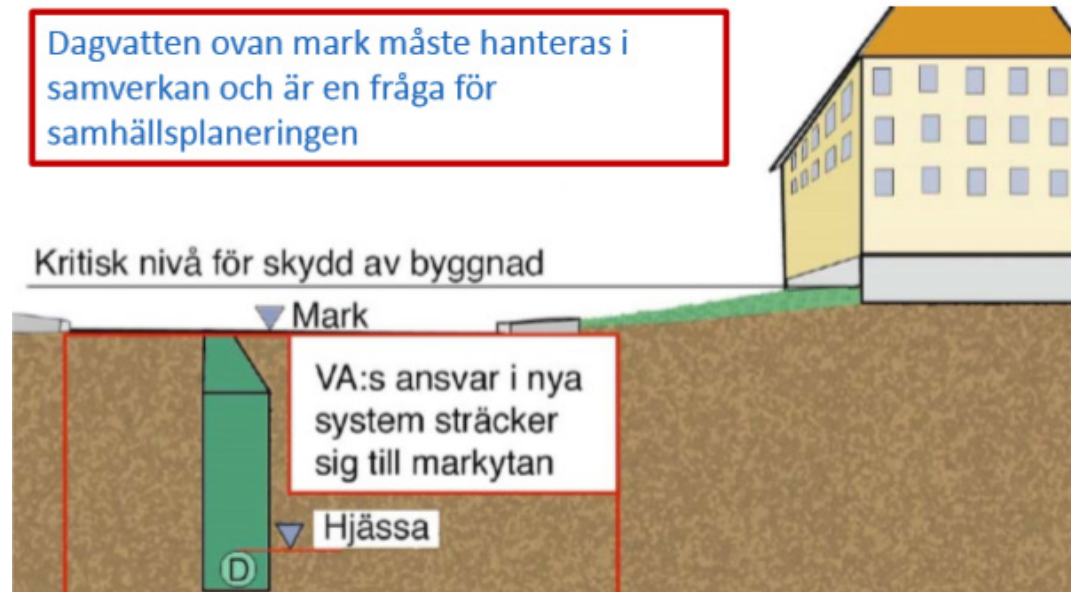
Figur 1. Funktionskrav för nya dagvattenledningar (Källa: PI 10)
