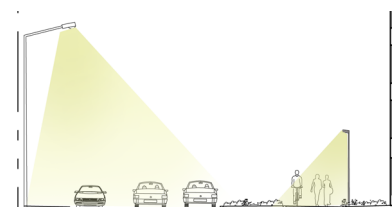
Margretelundsvägen, 8 meters stolpe gata och 4 meters stolpe på gång-och cykelväg
