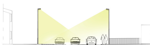
Simborgarvägen, befintlig 6 meters stolpe kompletteras med ny belysning mot de nya låghusen
