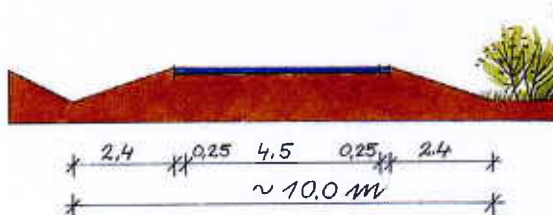
Principsektion för övrig lokalgata med 4,5 m körbana.
