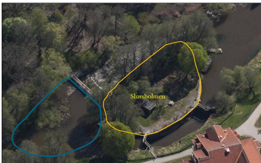
Figur 42. För att återställa det vattendjup som förelåg uppströms dämmet när det var nyanlagt kommer vassruggen och sediment inom blå markering att avlägsnas/muddras.
