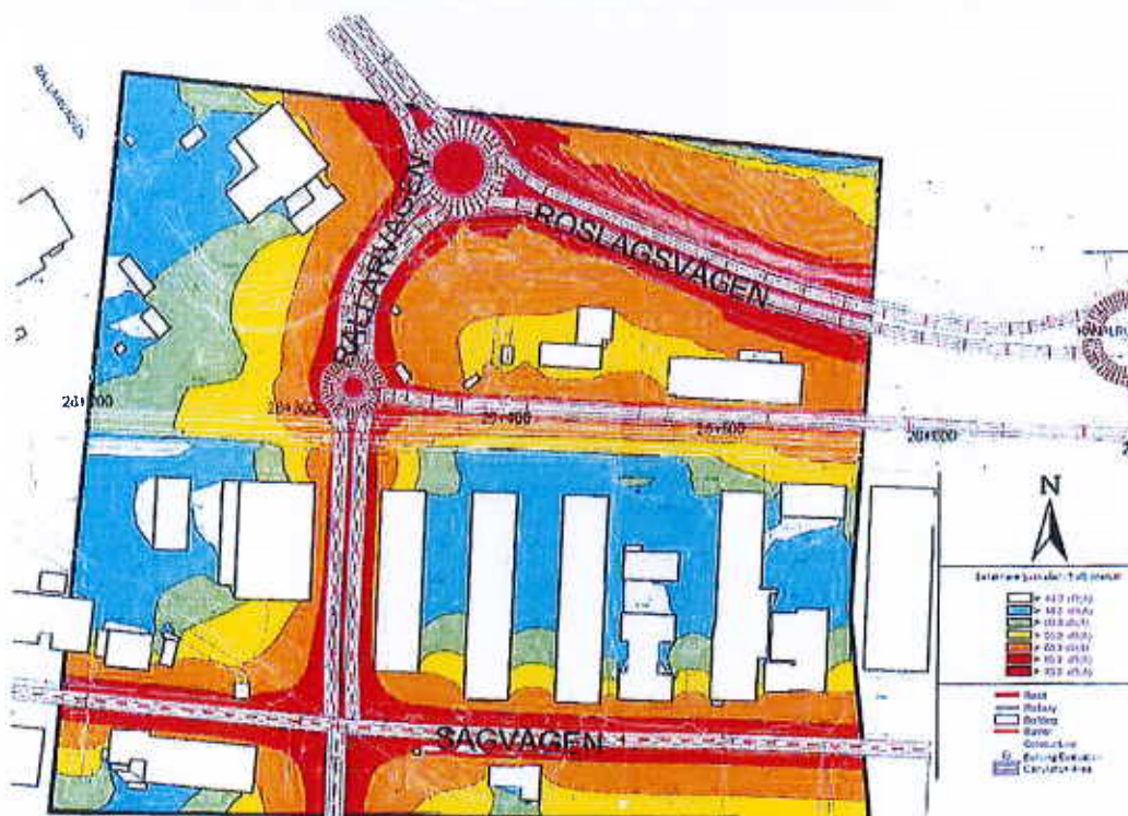
Beräknade ekvivalenta bullernivåer från vägtrafik vid den nya entrégatan (bilden har beskurets). WSP.
